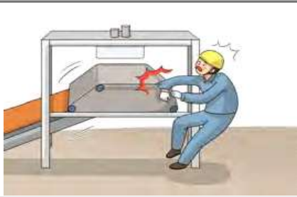
마그네틱 컨베이어 롤러 사이의 이물질 제거 중 끼임
