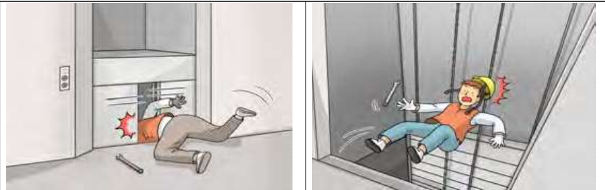
승강기 비전문가의 임의 수리·조작으로 불시 작동에 인한 끼임 및 떨어짐
