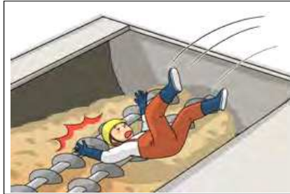
음식물쓰레기 처리시설 호퍼에 떨어져 블레이드에 끼임
