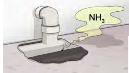
설비 정기점검 부실로 암모니아(NH3)가 누출되어 폭발함
