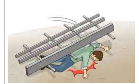
작업 중인 근로자가 철근구조물에 깔림
