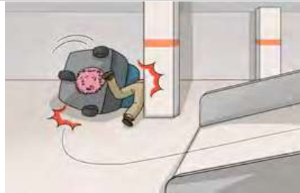
탑승식 청소차로 경사면을 내려오다 전복되어 기둥과 청소차 사이에 끼임
