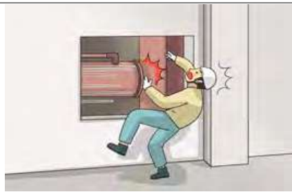
압축기 청소 작업 중 끼임
