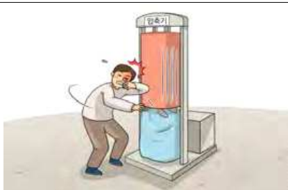
쓰레기 압축작업 중 튀어나온 파편에 맞음
